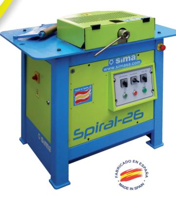
Los modelos **SPIRAL 26 y SPIRAL 36** son máquinas especialmente diseñadas para la elaboración de cualquier estructura de ferralla en espiral, así como de grandes arcos, como los empleados en la construcción de depósitos y estanques, columnas circulares, bóvedas, túneles y cauces circulares. Realizan espirales o arcos en acero de 6 mm, 26 mm y 32 mm, según modelo y resistencia de
